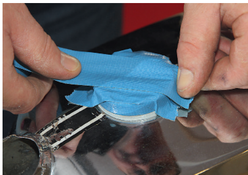
Notfalls macht Panzertape den Tank dicht. Besser sind jedoch passende Deckel aus der Schrottkiste
