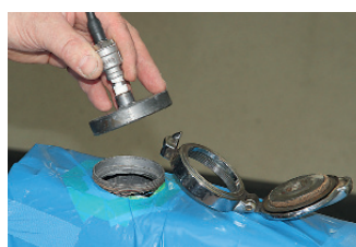
Den Tankverschluss ersetzen wir durch ein passendes Universalteil
