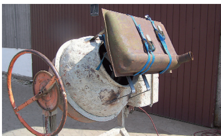
Solch massive Ablagerungen im Kraftstoffbehälter sind allein chemisch nicht zu knacken und...
