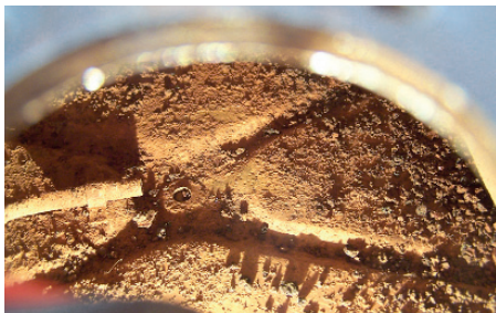
Solch massive Ablagerungen im Kraftstoffbehälter sind allein chemisch nicht zu knacken und...
